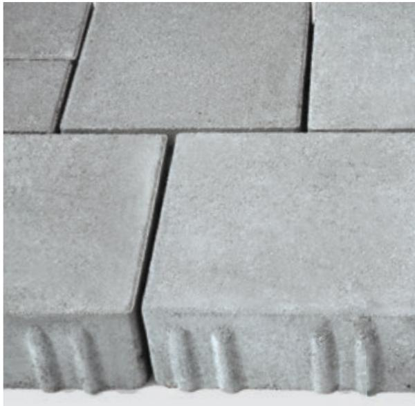
An jeder Steinreasterstrecke befinden sich Distanz-Verbundelemente, die so angeordnet sind, dass sie bei jedem Verlegeverband mit dem benachbarten Stein eine Verzahnung eingehen. Dadurch wird die Verschiebesicherung gewährleistet.
